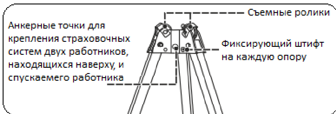
Рис. 2. Анкерные точки в головной части треноги.
